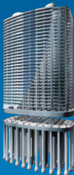
基礎と免震構造、タワー本体の概念図。先の新潟県中越地震でも、免震構造を採用した建築は、ほとんど被害がなかった。05年9月、建設中の『FORESIS』。免震構造の上に高強度コンクリートが打設され、ツインタワーのベースが完成しつつある
